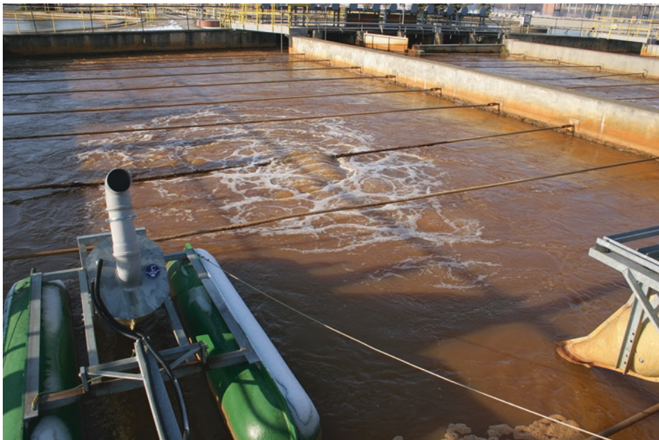
Abb. 3.7 Belüftung von Grubenwasser in einer Dünnschlammanlage (Grubenwasserreinigungsanlage Schwarze Pumpe, Lausitz)
