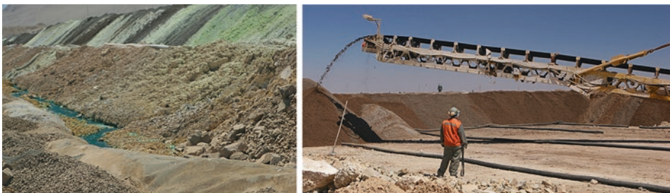
Abb. 5.4 Links: Auffanggraben der kupferhaltigen Lösung aus der Haldenlaugung; rechts: Vorbereitung einer Halde zur mikrobiologisch unterstützten sauren Laugung kupferreicher Erze (Kupferbergwerk El Salvador der Corporación Nacional del Cobre de Chile – Codelco)
