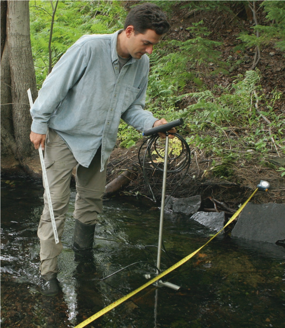
Abb. 2.9 Durchflussmessung mit einem akustisch-digitalen Strömungsmessgerät in einem durch Grubenwasser beeinflussten Bach (Kap-Breton-Insel, Neuschottland, Kanada). Der Bearbeiter steht korrekt abstromig des Messgeräts und hält das Gerät weit weg vom Körper, um den Durchfluss möglichst nicht zu beeinträchtigen
