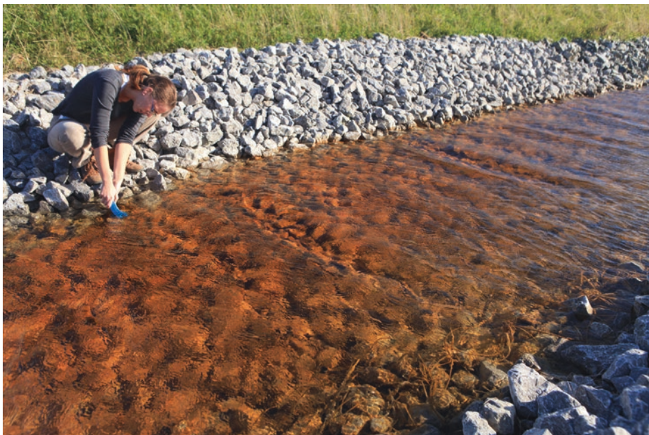
Abb. 4.6 Offenes Carbonatgerinne mit Eisenhydroxidausfällungen am Grubenwasseraustritt des ehemaligen Kohlenbergwerks Dominion № 11 auf der Kap-Breton-Insel, Neuschottland, Kanada
