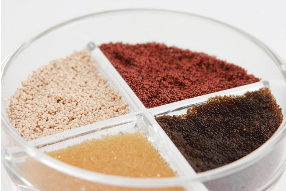
Abb. 3.28 Verschiedene Kunstharze für Ionenaustauscher (LANXESS Deutschland GmbH)
