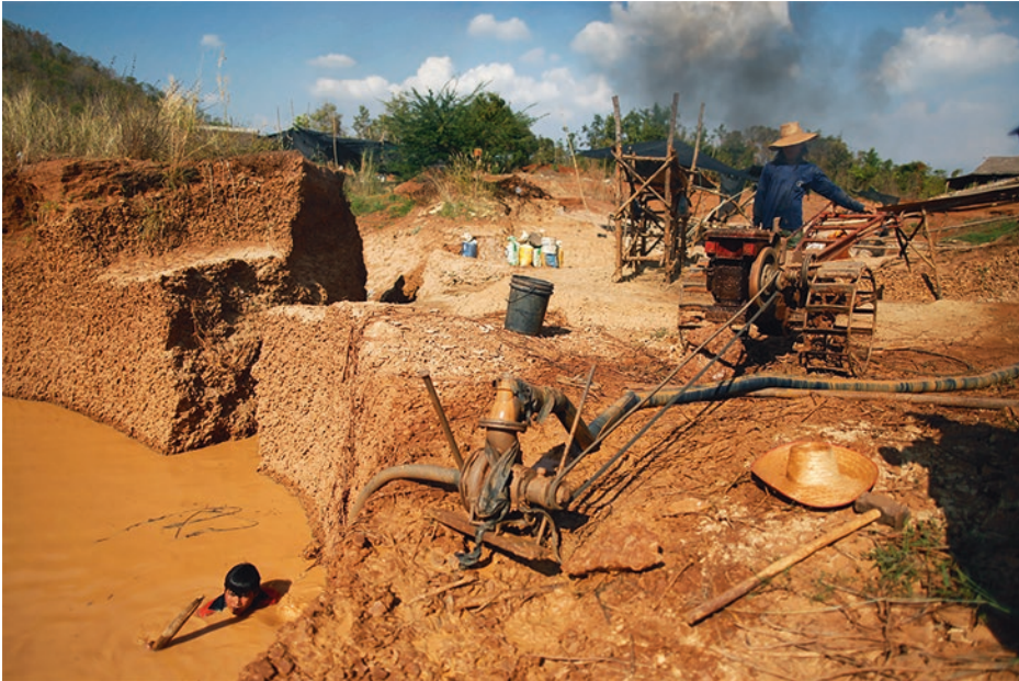
Abb. 1 Kleinbergbau auf Gold in Panompa bei Phichin in Thailand. Zwei Arbeiter installieren eine Pumpe zum Sumpfen ihres Abbaues. (© REUTERS/Damir Sagolj)
