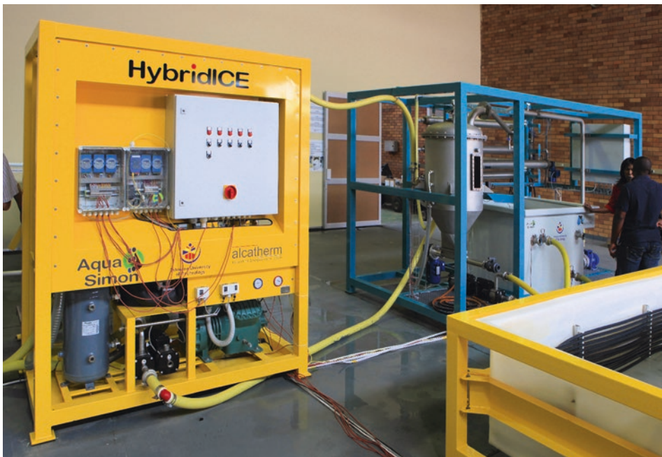
Abb. 3.32 Ehemalige Wasserreinigungsanlage zur eutektischen Gefrierkristallisation auf dem Soshanguve-Campus der Technischen Universität Pretoria (Tshwane University of Technology; HybridICE-Verfahren)
