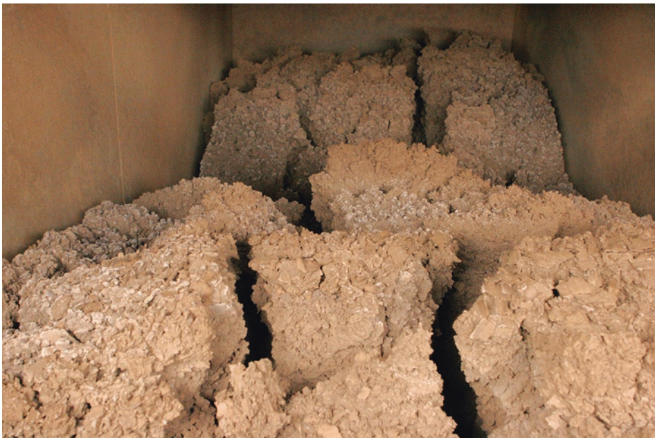
Abb. 3.8 Durch Filterpressen entwässerter Schlamm (Sauerwasserreinigungsanlage Flughafen Halifax, Neuschottland, Kanada; Bildbreite ca. 1 m)
