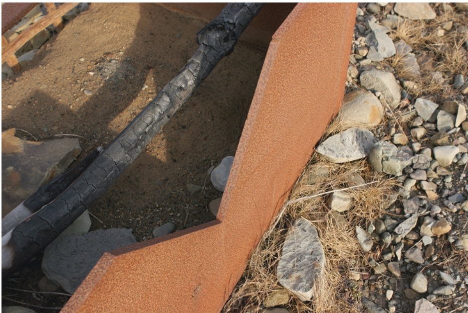
Abb. 2.11 Falsch konstruiertes Dreieckswehr für einen Grubenwasseraustritt des 1 B Mine Pools auf der Kap-Breton-Insel, Neuschottland, Kanada. Die Wehrplatte ist zu dick (2 cm), besteht aus nichtrostfreiem Material, und es fehlt die abgeschrägte, wasserseitige Abrisskante. Das Messwehr war über einen Zeitraum von ca. 1 Jahr im Einsatz, um Durchflüsse mit „hoher Genauigkeit“ zu messen
